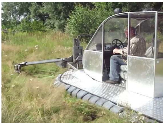
Rys. 14. Model rzeczywisty Poduszkowcowego Nośnika Narzędzi z kosą czołową, podczas pierwszych eksploatacyjnych prób terenowych
