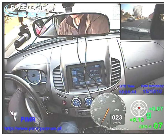
Rys. 7. Widok obrazu głównego przesyłany jest z kamery zamontowanej pod dachem samochodu Mitsubishi L200, natomiast PIP (obraz w obrazie) rejestruje widok drogi z kamery zamontowanej na szybie samochodu
