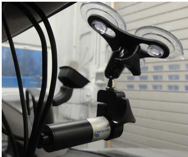
Rys. 5. Kamera wideo zamontowana na przedniej szybie samochodu Mitsubishi L200
