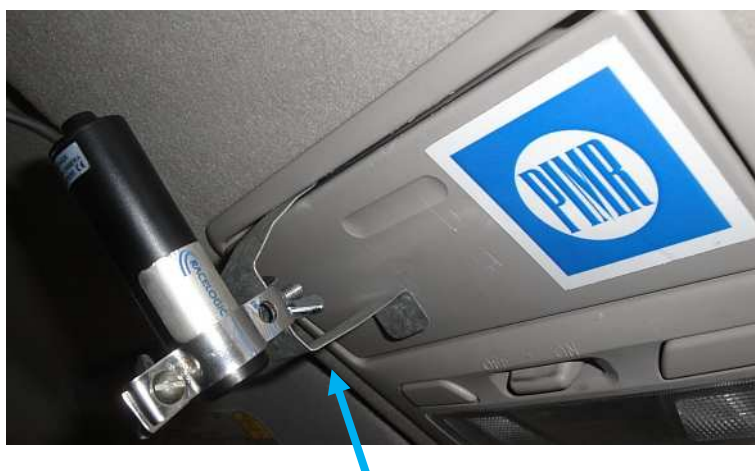
Rys. 6. Kamera wideo zamontowana w uchwycie opracowanym w PIMR-BE
