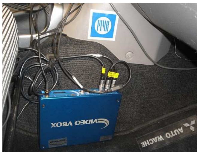
Rys. 4. Urządzenie Video VBOX zamontowane z lewej strony nóg pasażera w samochodzie Mitsubishi L200
