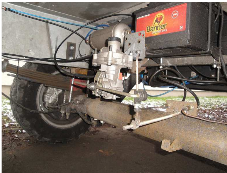
Rys. 1. Zawór LSV w naczepie GN2000 zamontowany w pobliżu akumulatora zasilającego układ hamulcowy PEBS
