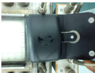
Rys. 4 antena GPS zainstalowana na wózku defektoskopowym
