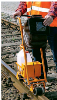
Rys.3 Pomiar szyny wózkiem defektoskopowym [źródło PLK-SA]
