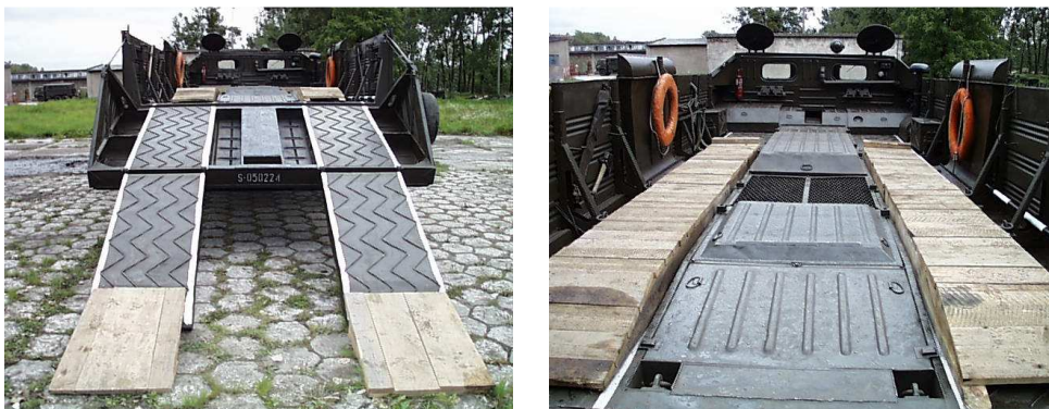
Rys.4. Niektóre z elementów adaptacyjnych transportera PTS dla potrzeb realizacji zadań ewakuacji ludności, inwentarza, pojazdów i urządzeń
