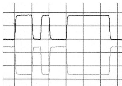
Rys.5. Rzeczywiste, przykładowe przebiegi napięcia magistrali CAN [11]
