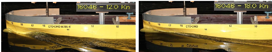
Rys. 1. Działanie gruszki dziobowej dla nieoptymalnej (po lewej) i optymalnej (po prawej) prędkości. Źródło: materiały CTO S.A.
