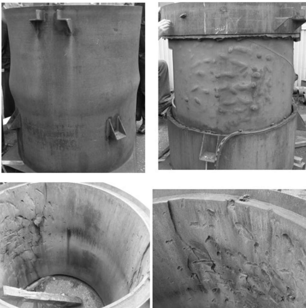
Rys. 5 Zbiornik ze stali 18G2 po detonacji.
