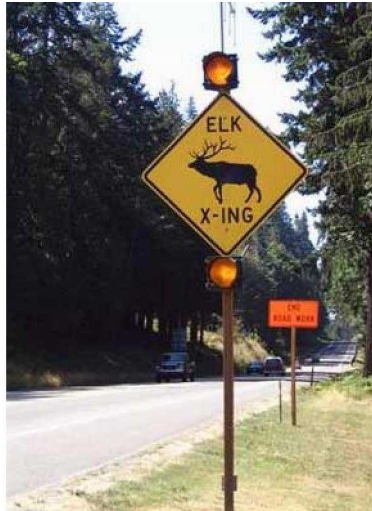
Fot. 6. Znak drogowy z migającym reflektorem uruchamianym w przypadku wykrycia zwierząt [3]
