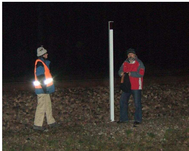
Fot. 1.-2. Elementy odblaskowe: wygląd i wysokość mocowania w przypadku instalacji na linii kolejowej [15]
