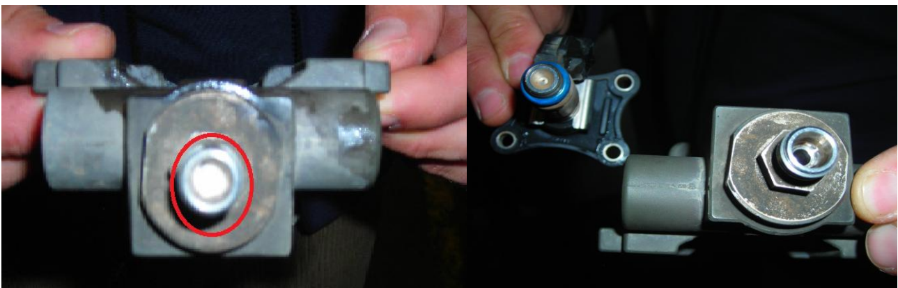
Rys. 7. Zdjęcie modułu dozującego przed i po regeneracji,[1].
