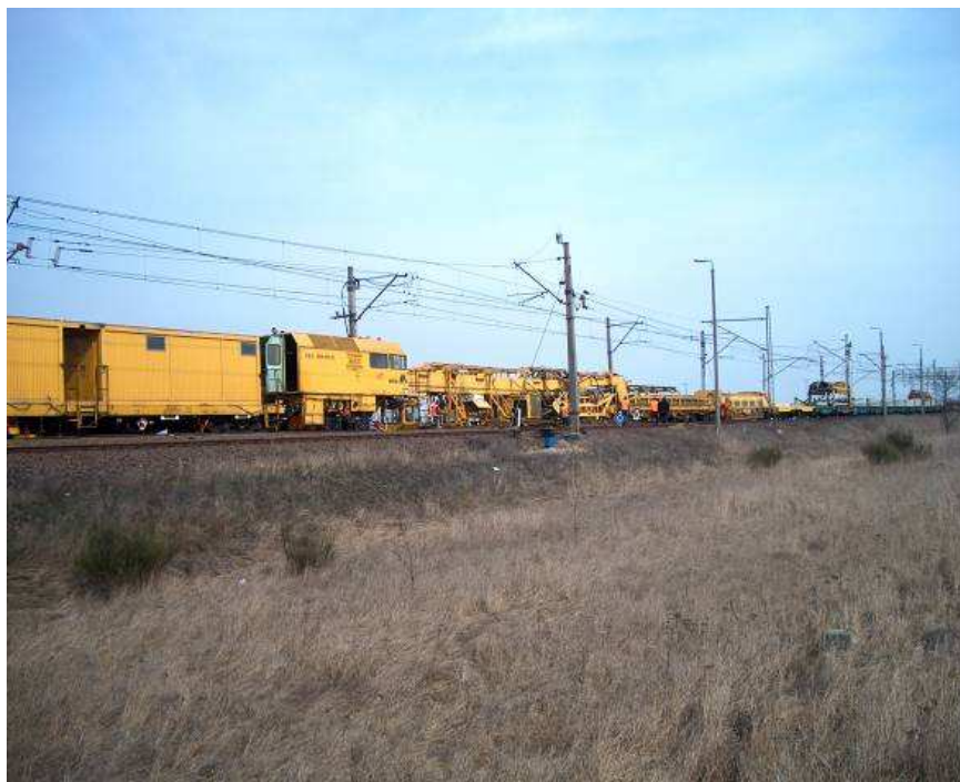
Rys. 1 Pociąg potokowej wymiany nawierzchni P-93 - PUN
