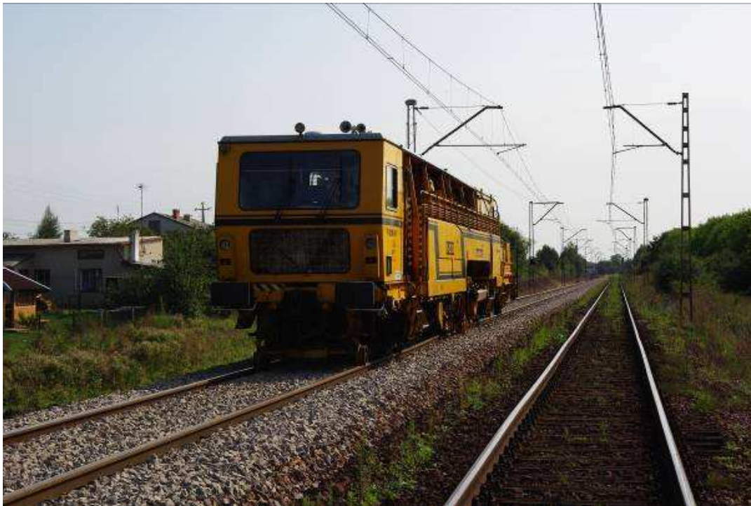
Rys. 7 CSM - wysokowydajna podbijarka toru
