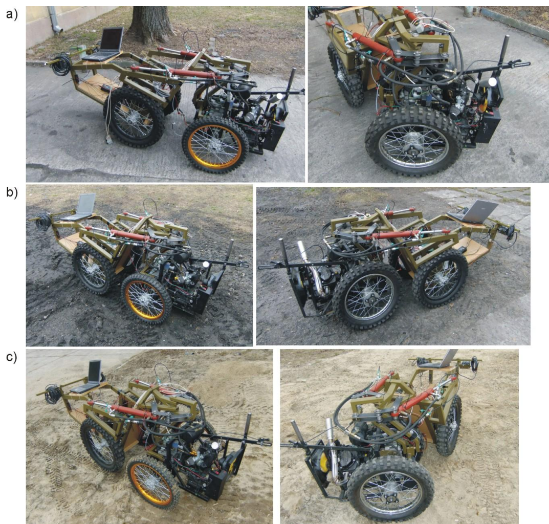
Rys.2. Kolowa platforma testowa z dwoma rodzajami kół podczas badań na: a) podłożu betonowym, b) gruncie o nośności CI = 280 kPa, c) gruncie o nośności CI = 150 kPa
