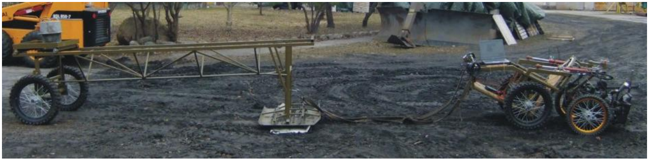
Rys.6. Kolowa platforma testowa podczas próby wyznaczenia współczynnika przyczepności na podłożu gruntowym
