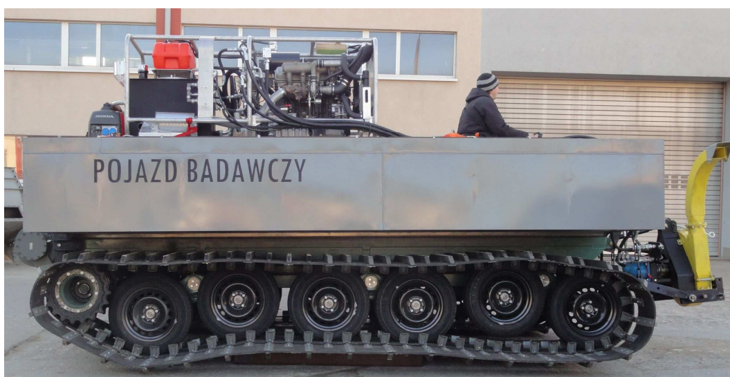
Rys. 1. Przedprototyp gaśienicowego pojazdu badawczego w widoku z boku, na nadwoziu zamocowano pasami agregat hydrauliczny do napędu maszyn i narzędzi wypożyczony na czas prowadzenia prób przez firmę Hydromega
