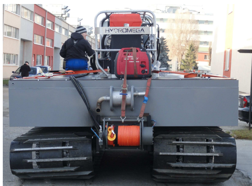
Rys. 3. Przedprototyp gasienicowego pojazdu badawczego w widoku z tyłu, mały agregat prądowórczy służy do zasilania aparatury kontrolno-pomiarowej, za nim widoczny agregat hydrauliczny Hydromega, w lewym górnym narożniku nadwozia widoczny otwór odpływu wody z pompy zęzowej
