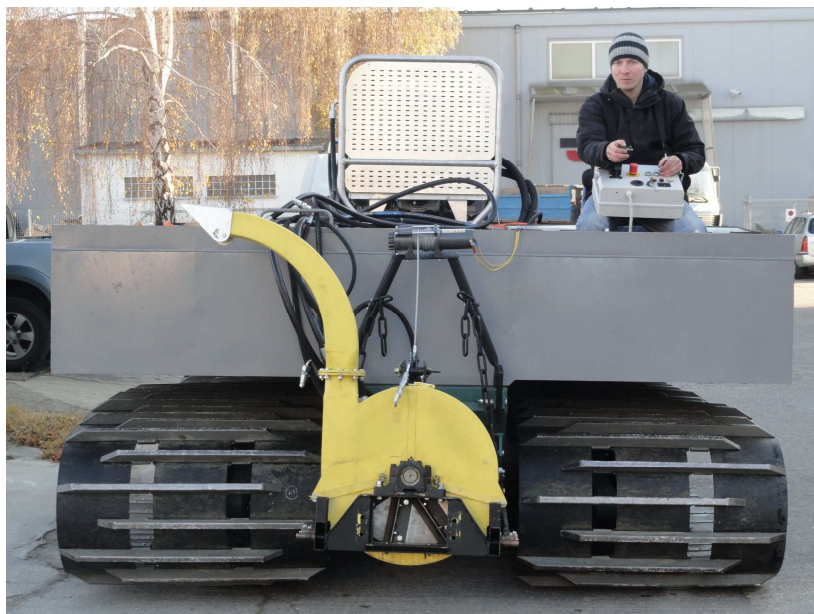
Rys. 2. Przedprototyp badawczego pojazdu gasienicowego - w widoku z przodu z zamontowanym rozdrabniaczem wirnikowym zamontowanym na trzypunktowym układzie zawieszenia narzędzi, wciągarka elektryczna służy do ustalania wysokości położenia narzędzia względem podłoża
