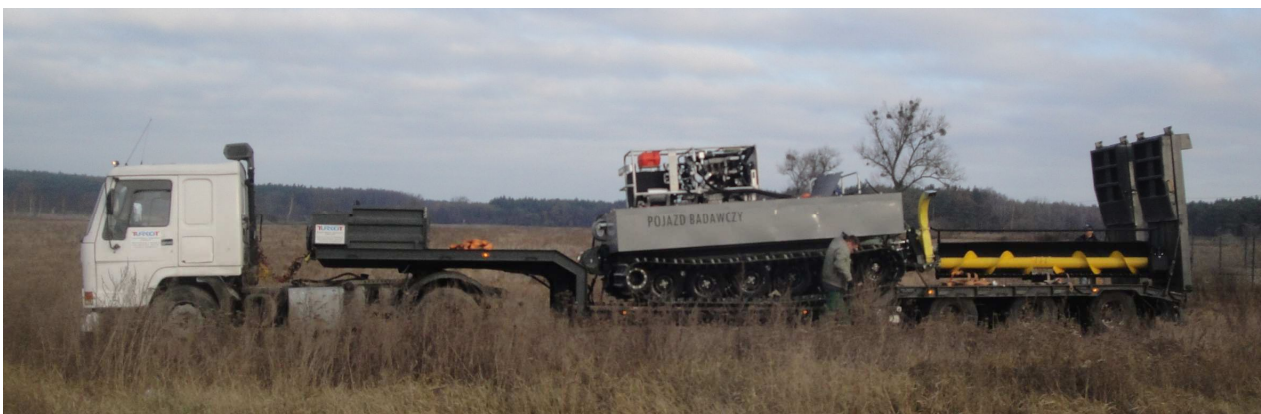
Rys. 5. Przedprototyp pojazdu badawczego z narzędziami na niskopodwoziowej naczepie
