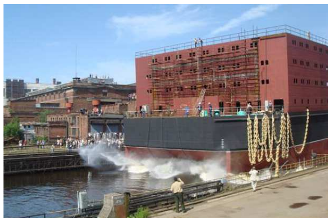
Rys. 7. Wodowanie barki FNPP z reaktorami atomowymi i elektrowni o mocy 70MW w dniu 30.06.2010. Źródło: [8].
