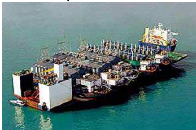
Rys. 5. Statek przygotowany do podróży z 5 elektrowniami na barkach pływających oraz 1 barką paliwową (bunkierką). Źródło: [2].
