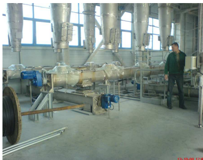
Rys. 3. Przenośnik śrubowy wykonany z z materiału KO w ciągu technologicznym zakład produkcyjny WĘGRY
