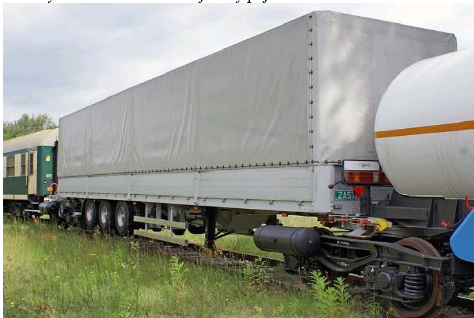
Rys.12. Transport bimodalny naczep na wózkach kolejowych z adapterami
