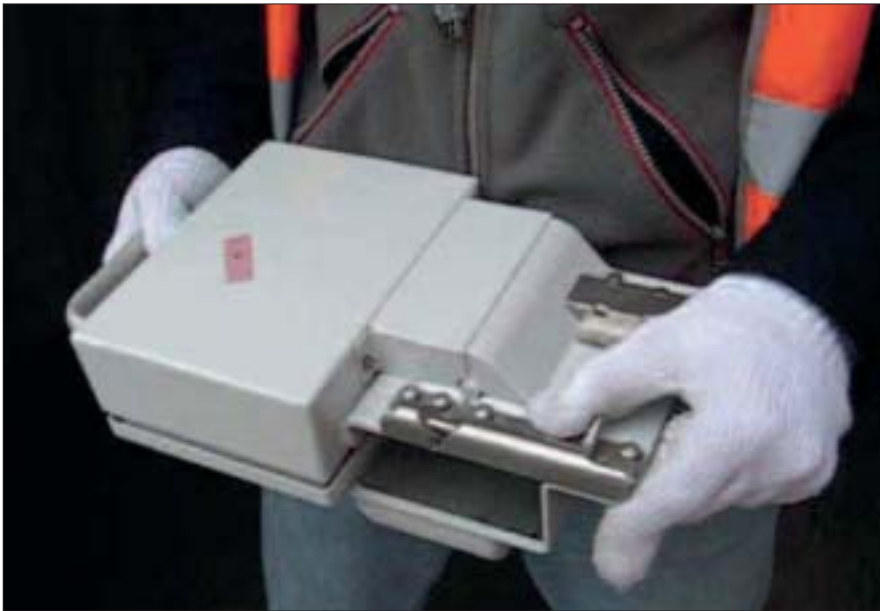
Fot. 2. Prototyp urządzenia TREC gotowego do montażu na drzwiach kontenera. Źródło: Dolivio F.: „The IBM Secure Trade Lane Solution”, ERCIM News, No 68, January 2007, s.46.
