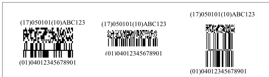
Rys. Przykłady: a) Symbolu Złożonego Spiętrzonego RSS-14; b) Symbolu Złożonego Ograniczonego RSS; c) Symbolu Złożonego Spiętrzonego Wielokierunkowego RSS-14; W symbolu RSS zakodowany jest GTIN, natomiast Identyfikator Zastosowań (17) – data ważności i (10) – numer partii zakodowano w elemencie złożonym A
