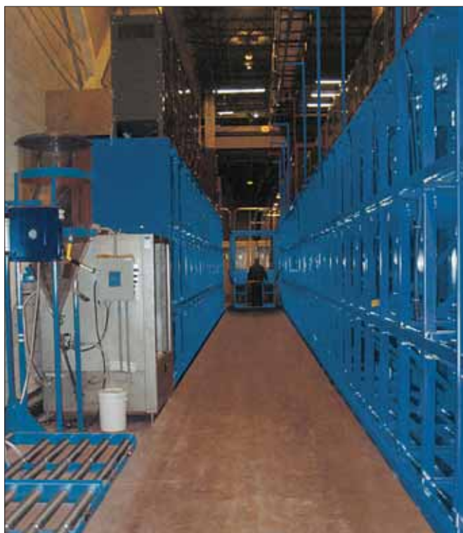
Rys. 6. Wózek napędzany serii BBH do wymiany baterii akumulatorów przy trójpoziomowym układzie stanowisk do ich ładowania. Źródło: Materiały informacyjne producenta
