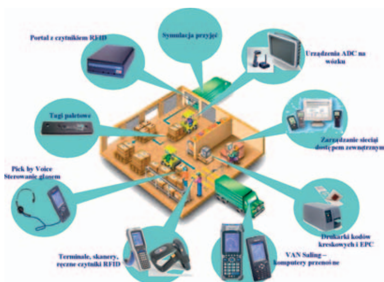
Rys.6. Schemat ideowy wraz z wykazem testowanych w „Magazynie Przyszłości” technologii.
