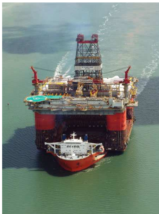
Rys. 39. Ciężarowiec „Blue Marlin” z wieżą „Thunder Horse”
