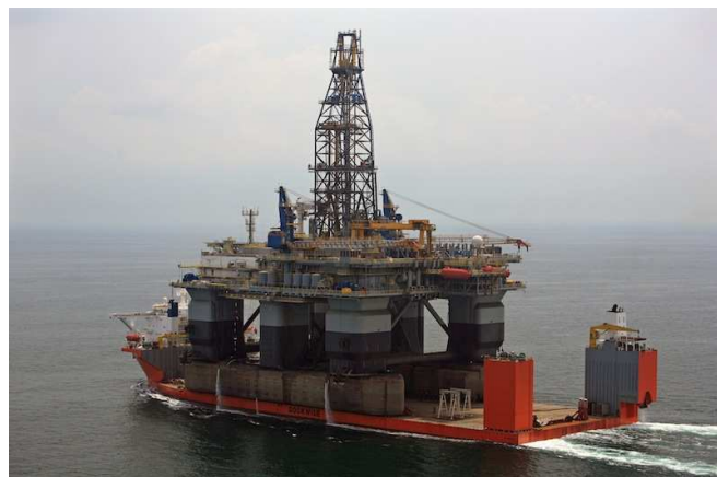
Rys. 5. Statek półzanurzalny z ładunkiem ponadgabarytowym ciężkim przestrzennie Źródło: http://www.dockwise.com/page/projects/noble_jim_day.html
