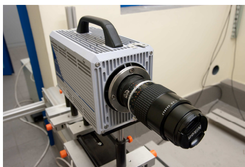
Rys. 1. Komora o stałej objętości do badań rozpylenia paliwa (a) oraz kamera do zdjęć szybkich HSS5 firmy LaVision (b)
