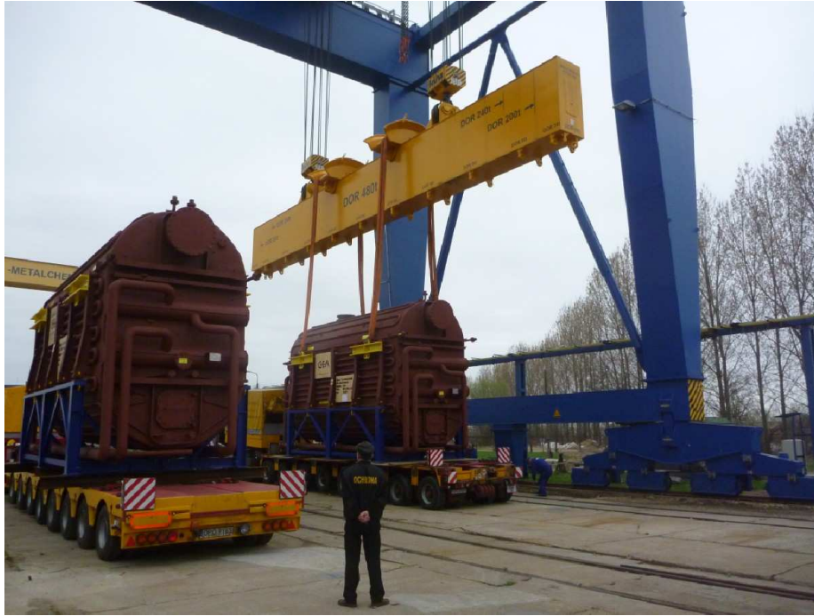
Rys. 1 Załadunek suwnicą 500 to w Opolu
