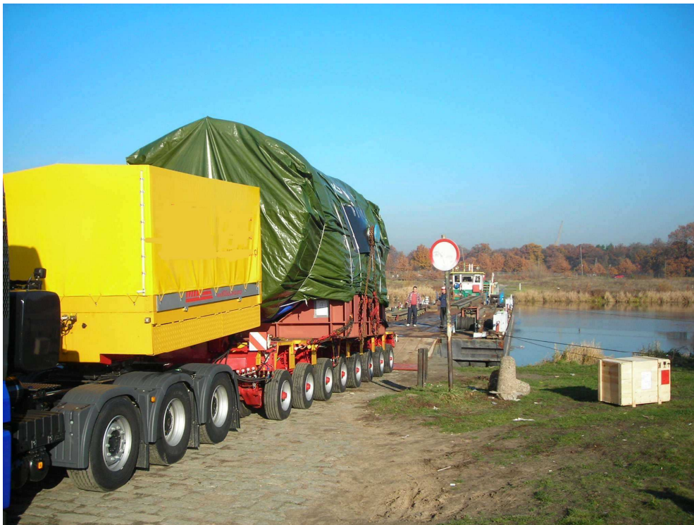
Rys. 3 Załadunek generatora ALSTOM na ponton W-2 we Wrocławiu
