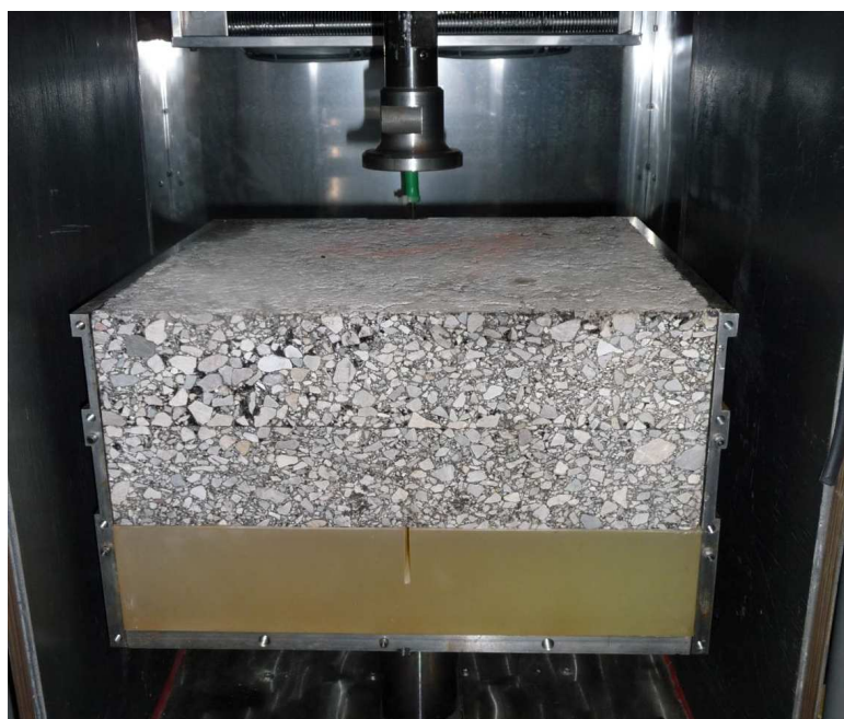
Rys.5. Próbką umieszczona w przystawce, przed założeniem przedniej części obudowy.
