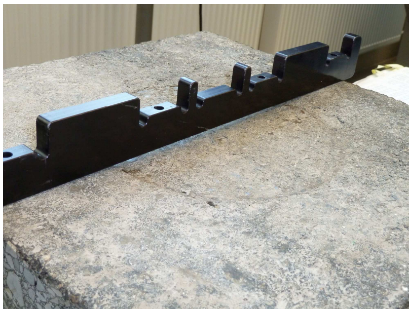
Rys.9. Górna powierzchnia próbki po zakończeniu badania zmęczeniowego w 30[^\circ\text{C}] z uwzględnieniem zbrojenia siatką.
