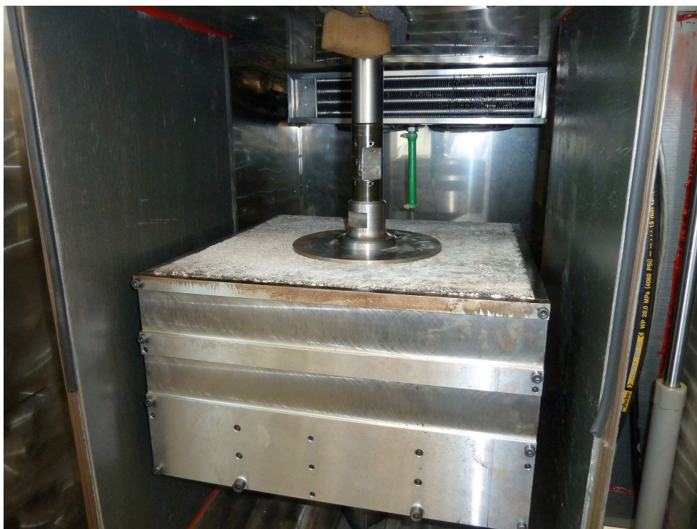
Rys.3. Przystawka z próbką o maksymalnej możliwej wysokości h_2 = 150[\text{mm}] umieszczona w komorze temperaturowej.
