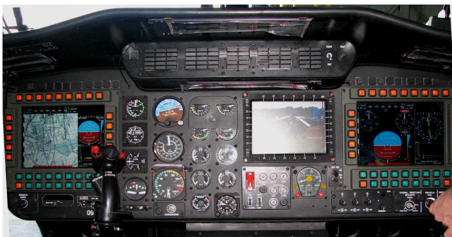
Rys. 2. Widok kabiny z elementami zintegrowanego systemu łączności ZSŁ opracowanego przez ITWL i zabudowanego na śmigłowcu W-3PL
