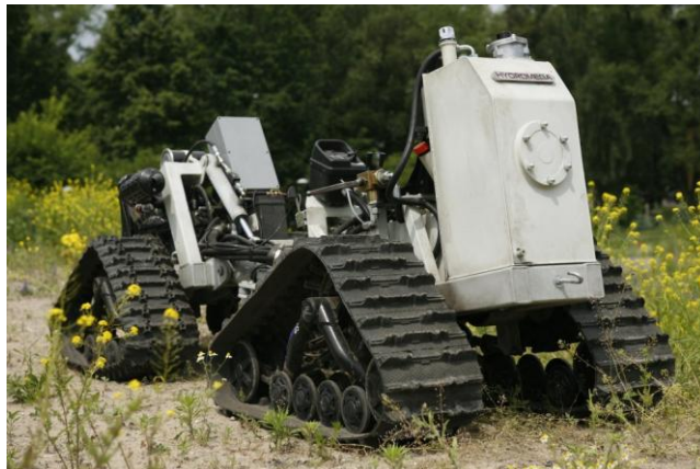
Rys.10. Zdalnie sterowana, bezzałogowa platforma lądowa Dromader: a) element sterujący Spektrum DX3S, b) widok platformy
