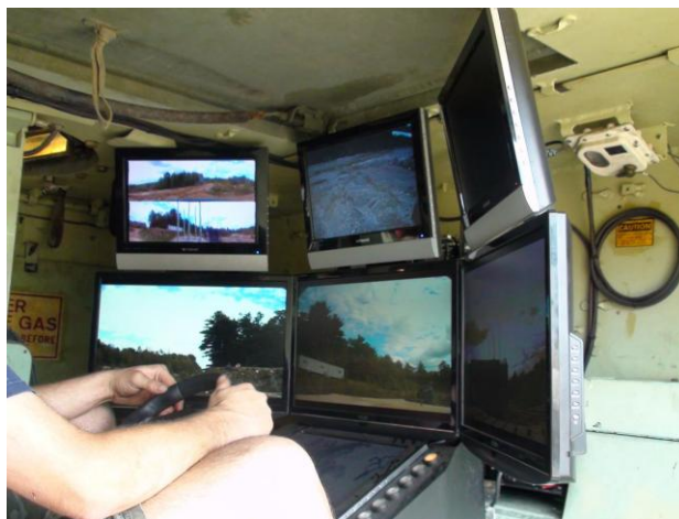
Rys.1. Eksperymentalne stanowisko sterowania szybkobieżnej platformy RipSow wewnątrz transportera MI13 - efektywna teleoperacja wymaga zastosowania rozbudowanych systemów zobrazowania otoczenia oraz sterowania i kontroli [10]
