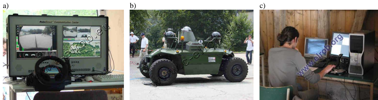
Rys.7. Wybrane przykłady istniejących stacjonarnych pulpitów sterowania pojazdami bezzałogowymi: a) pulpit robota Robo-Scout, b) robot Robo-Scout, c) pulpit robota Lisa [7,8]
