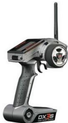
Rys.10. Zdalnie sterowana, bezzałogowa platforma lądowa Dromader: a) element sterujący Spektrum DX3S, b) widok platformy
