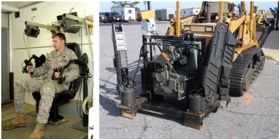
Rys.4. Eksperymentalne stanowisko sterowania zapewniające siłowe sprzężenie zwrotne z osprzętem platformy zbudowane w ramach programu ARTS (All-purpose Remote Transport System) [10]
