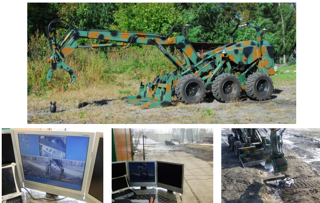
Rys.11. Stanowisko zdalnego sterowania robotem wsparcia inżynierskiego Marek
