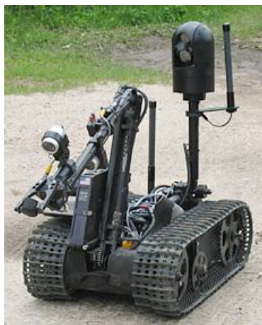
Rys.3. Robot EOD Talon wyposażony w system HARV [10]
