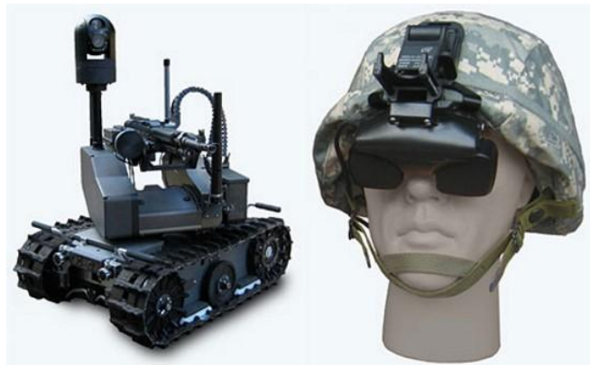
Rys.2. System HARV umożliwia sterowanie kamerą ruchami głowy [10]
