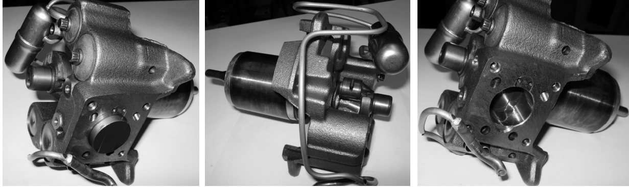
Rys. 3. Węzły ruchowe sprężarki tłokowej Embraco Aspera NE9213GK
