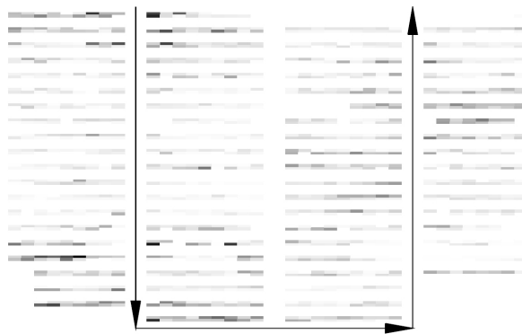
Rys. 1. Widok magazynu z lotu ptaka, gdzie odcinki regałów są zamalowane zgodnie z częstością zapytań o jednostki magazynowe tam składowane. Strzałki oznaczają domyślne ścieżki pracowników kompletacyjnych [3].
