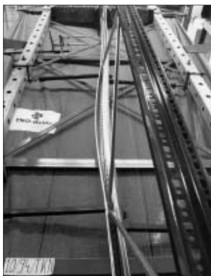
Ryc. 9. Skręcanie „otwartego” profilu słupa z jedna osią symetrii pod wpływem siły sciskającej
