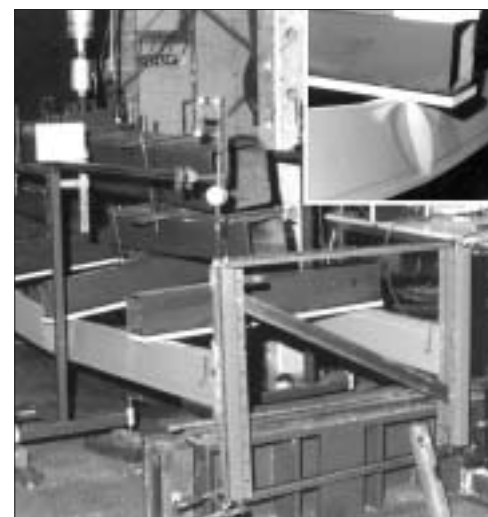
Ryc. 6. Badanie wytrzymałości na zginanie pary belek. Obciążenie punktowe stosuje się dla europalet (palet skrzyniowych)
