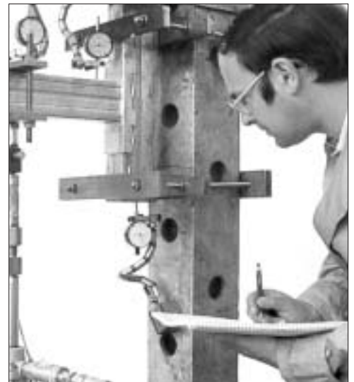
Ryc. 12. Stanowisko badawcze dla wyznaczenia sztywności węzła zaczepowego belki ze słupem
