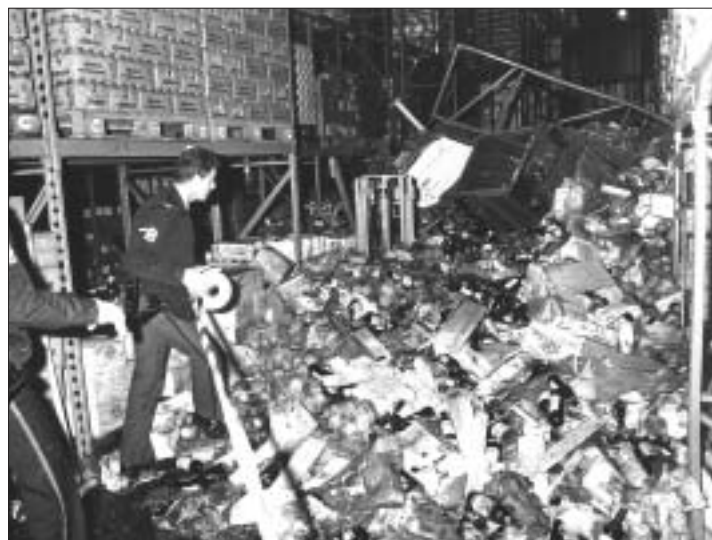
Ryc. 18. Awaria w regałowej strefie składowania
