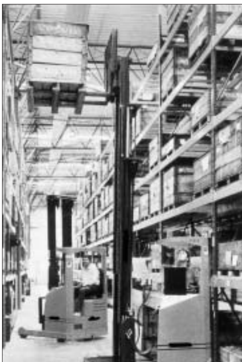
Ryc. 15. Wózek ustawiony przed regałem przed włożeniem palety do gniazda regału
