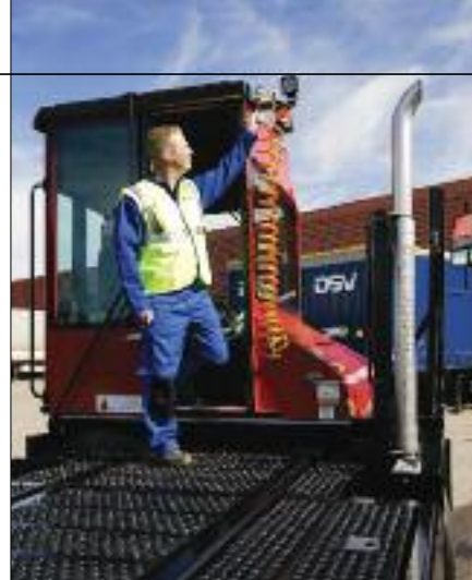
Fot. 3. Drzwi przesuwne w tylnej ścianie kabiny umożliwiający szybki dostęp do przewodów łączących ciągnik i naczepę.
