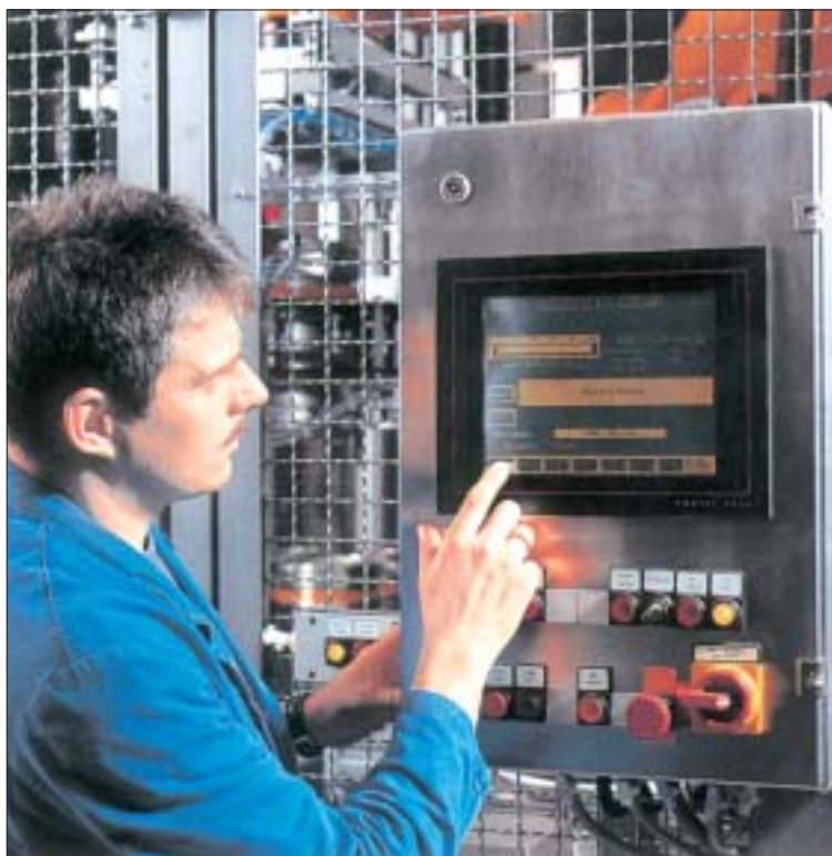
Rys. 2. Przykład programowania pracy robota z poza przestrzeni chronionej [3]
