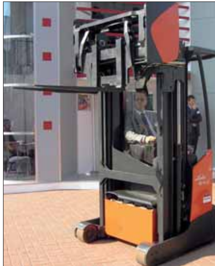
Rys. 3. Wózek podnośnikowy z masztem wewnętrznym nie obejmującym ładunku, w wysuwnej karetką (ang. reach truck with fork arm carriage). Źródło: materiały informacyjne firmy LINDE.
