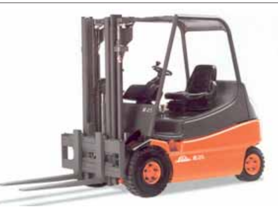
Rys. 1. Wózek podnośnikowy czołowy widłowy (ang. counterbalanced lift truck). Źródło: materiały informacyjne firmy LINDE.
