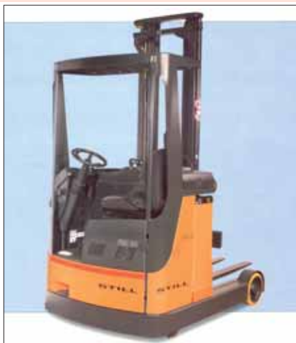
Rys. 2. Wózek podnośnikowy z masztem wewnętrznym nie obejmującym ładunku, w wysuwym masztem (ang. reach truck with retractable mast). Źródło: materiały informacyjne firmy STILL.
