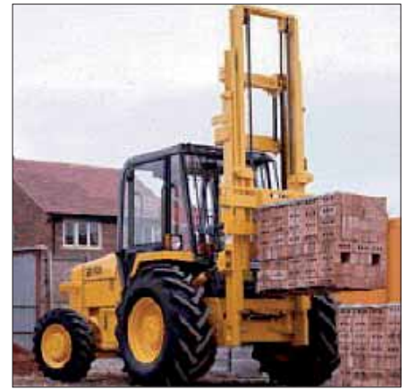
Rys. 11. Wózek podnośnikowy czołowy terenowy (ang. rough terrain truck). Źródło: materiały informacyjne producenta.
