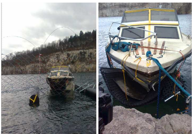
Rys. 9-10. Uszkodzenia siatki oraz łodzi „Calypso” po przeprowadzonych testach
