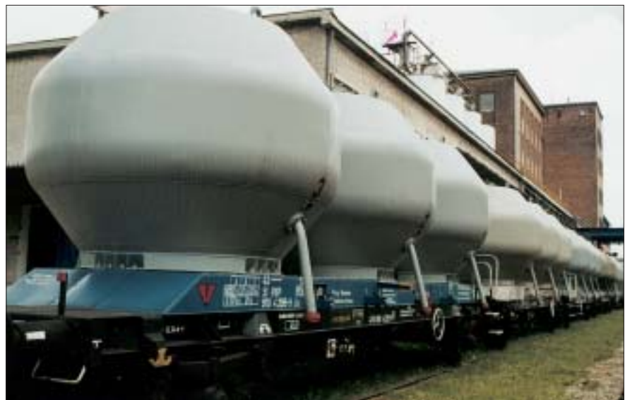
Ryc. 4. Cysterny kolejowe do przewozu PCW na stanowisku załadunku
