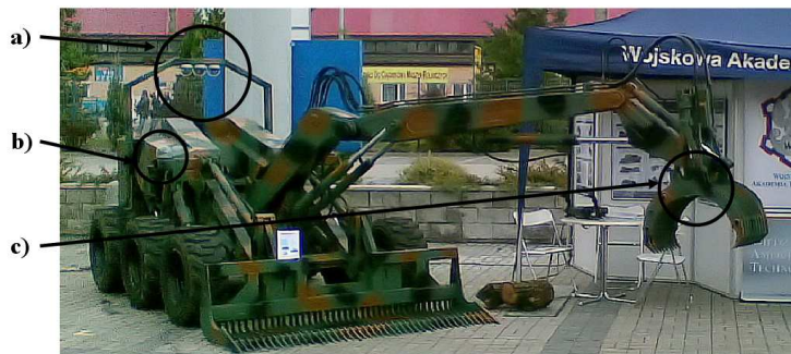
Rys.11. Inżynierski robot wsparcia z systemem wizyjnym: a) trzy kamery tworzące panoramę; b) dwie kamery pomocnicze/cofania; c) jedna kamera w chwytaku
