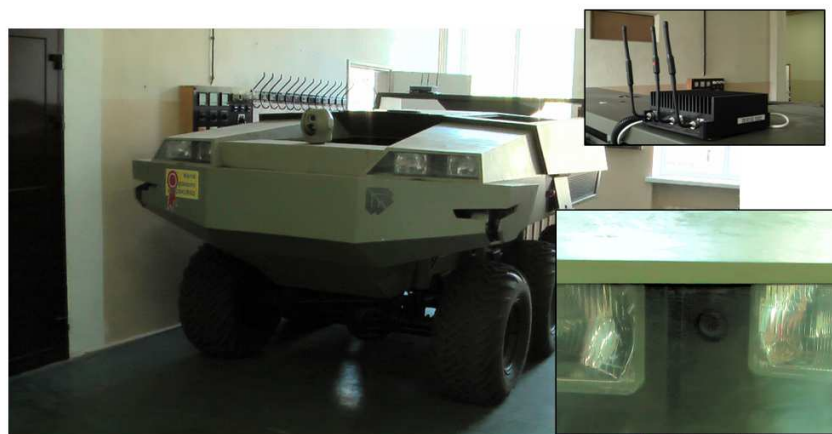
Rys.6. Pojazd Lewiatan 3 z zamontowanym łączem Ethernetowym i kamerami pomiędzy reflektorami oraz z głowicą obserwacyjną
