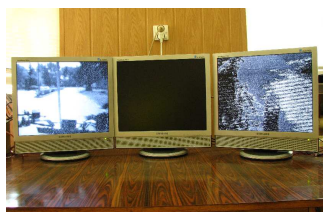
Rys.5. Test dwóch nadajników podczas jazdy z prędkościami powyżej 15 km/h: po lewej obraz z nadajnika pracującego na częstotliwości 1,3GHz, po prawej na częstotliwości 2,4GHz
