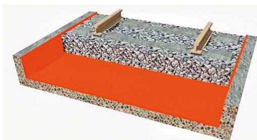
Rys.5. Podtorowa mata wibroizolacyjna w tradycyjnej nawierzchni podsypkowej [5]
