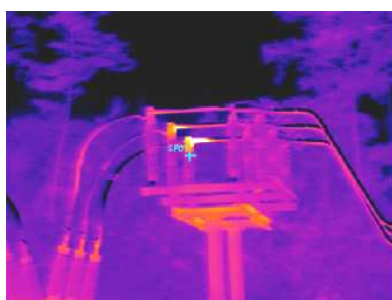
Rys.5 Przegrzane zaciski odłącznika
