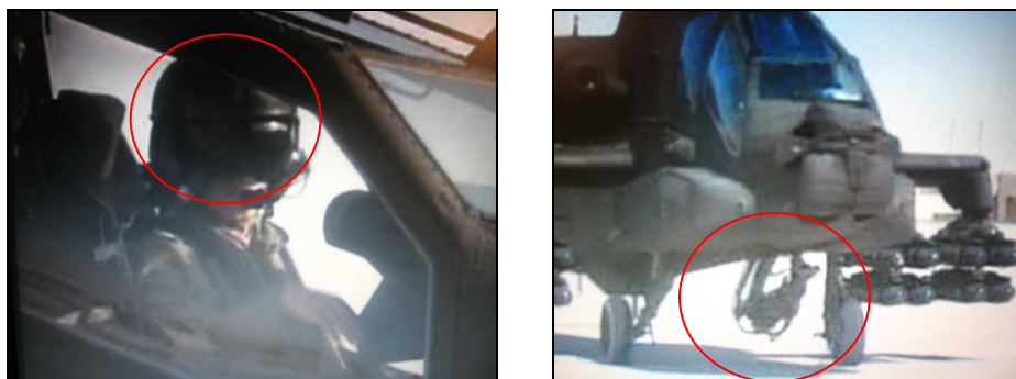
Rys.2. Widok nahałmowego systemu prezentacji danych IHADSS (po lewej) oraz elementy ruchomego karabinu maszynowego XM230 (po prawej) śmigłowca AH-64 APACHE
