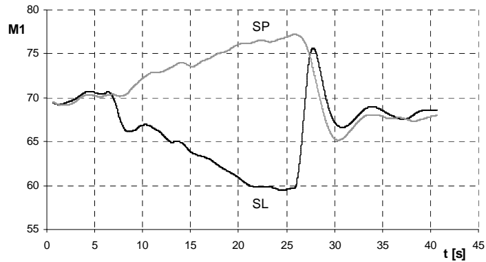
Rys. 7. Charakter zmian momentu obrotowego M_1 podczas wykonywania próby synchronizacji wg momentów w czasie ( M_1 \approx 70\% )
