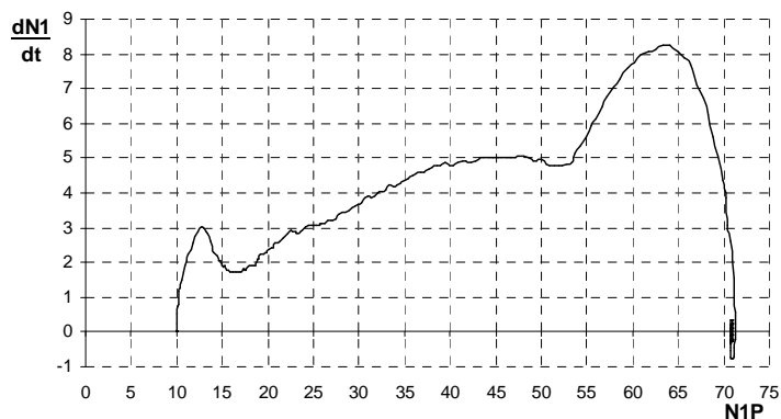
Rys. 2. Odzworowanie fazowe przyrostu prędkości obrotowej SP przy rozruchu.
