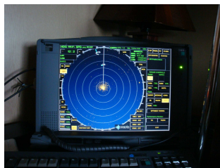
Rys.1. Przenośne stanowisko do rejestracji i przetwarzania zobrazowania radarowego Maris5000
