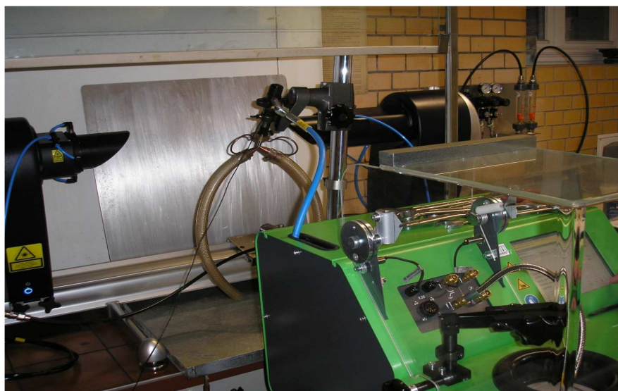
Rys. 3. Stanowisko badawcze rozkładu strugi wtryskiwanego paliwa
