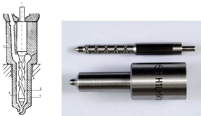
Rys. 2. Schemat i zdjęcie wtryskiwacza wielootworowego ze wstępną obróbką paliwa 1 – korpus rozpylacza, 2 – iglica, 3 – przestrzeń między iglicą a korpusem, 4 – kanały turbulacyjne
