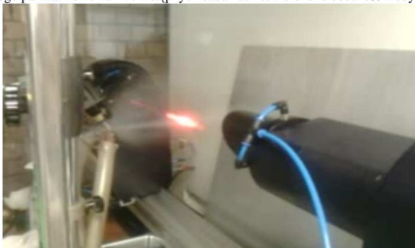
Rys. 4. Rejestracja strugi rozpylanego paliwa
