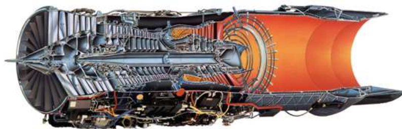
Rys. 2. Silnik turbinowy odrzutowy F100-PW-229 [2]
