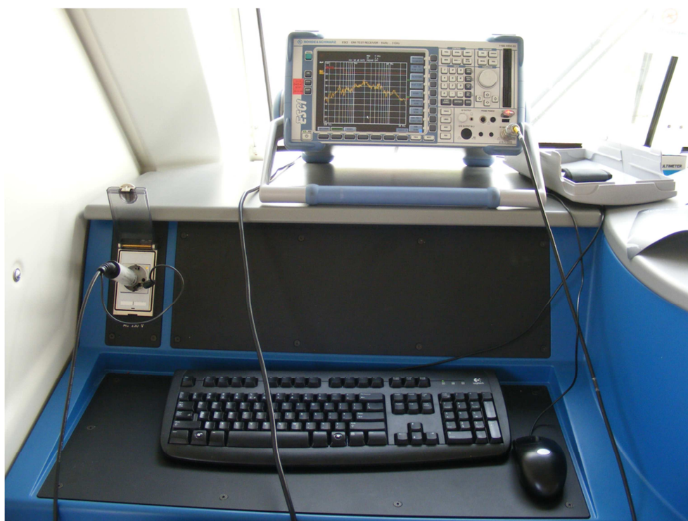
Rys.2. Układ pomiarowy do zaburzeń radioelektrycznych w pokładowej sieci zasilającej
