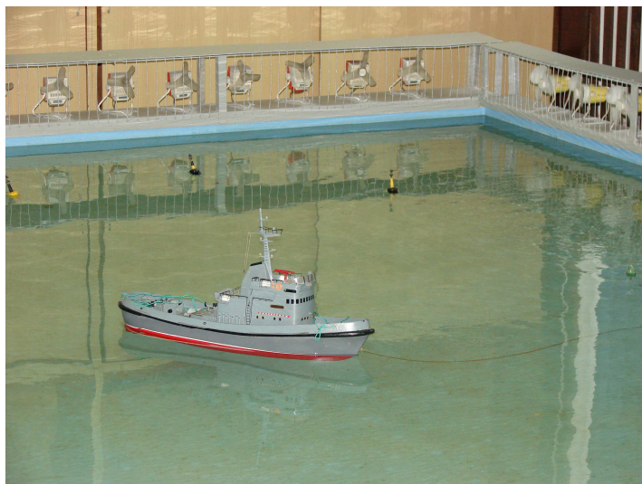
Fot 4. Jednostka jednośrubowa (holownik) podczas postoju na kotwicy.
