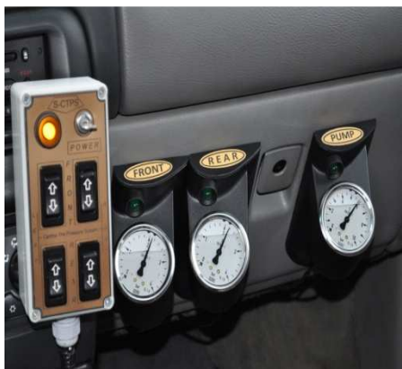
Rys. 4. Pulpit i blok sygnalizacyjny
