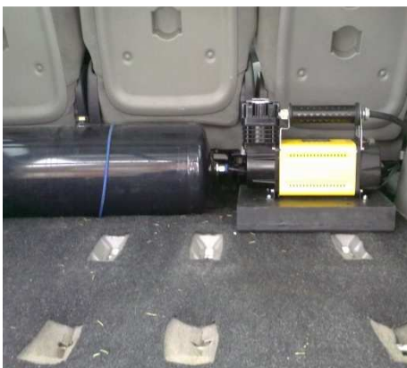
Rys. 5. Sprężarka i zbiornik powietrza
