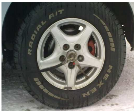
Rys. 2. Montaż piasty pneumatycznej
