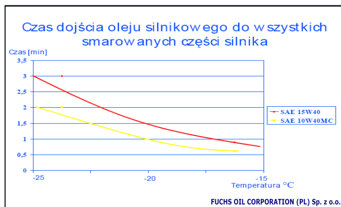
Rys. 2. Wykres czasu pełnego dojścia oleju do smarowanych części silnika
