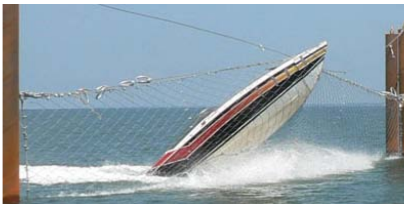
Rys. 7. Test wytrzymałościowy stałej bariery wodnej
