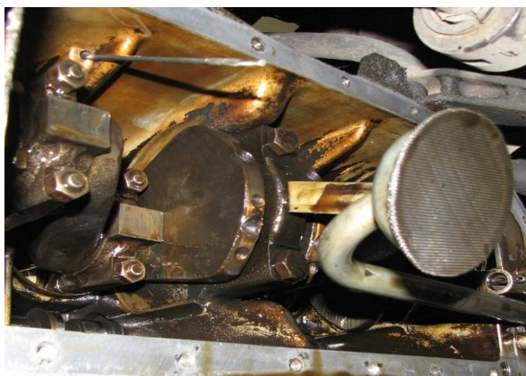
Rys.7. Widok ogólny silnika po zdemontowaniu miski olejowej smarowanego olejem mineralnym Lotos 15W-40 przez 10 000 km.
