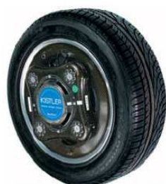
Rys. 2 Przykład przetwornika sił przenoszonych przez koło dla samochodu osobowego [1]
