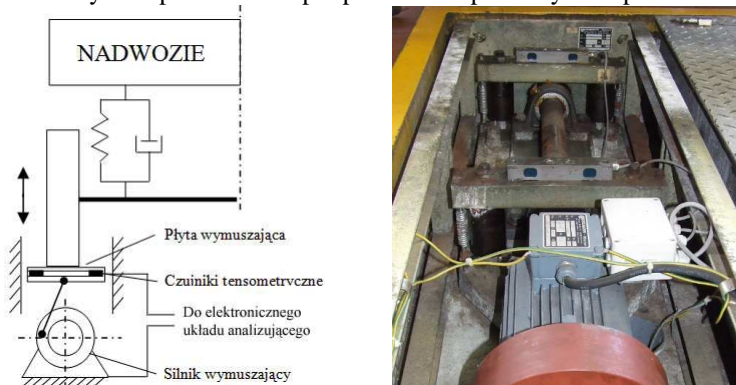
Rys. 3 Stanowisko wykorzystujące metodę EUSAMA: a) schemat, b) widok częściowo zdemontowanego urządzenia - na pierwszym planie widok silnika z kołem zamachowym a dalej widoczne dwa czujniki siły do których mocowana jest płyta wymuszająca
