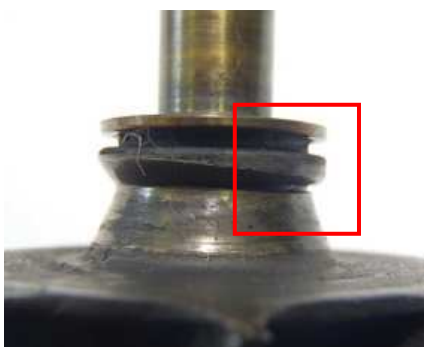
Rys.3.8. Część pierścieniowa a) element uszkodzony - skala 1:1, b) element nowy - skala 4:1
