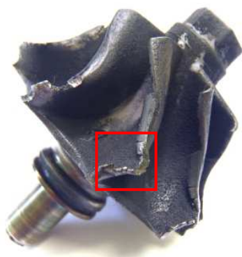
Rys.3.7. Zdeformowane łopatki turbiny a) skala 1:1, b) skala 4:1
