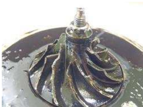
Rys.3.2. Uszkodzony wirnik sprężarki
