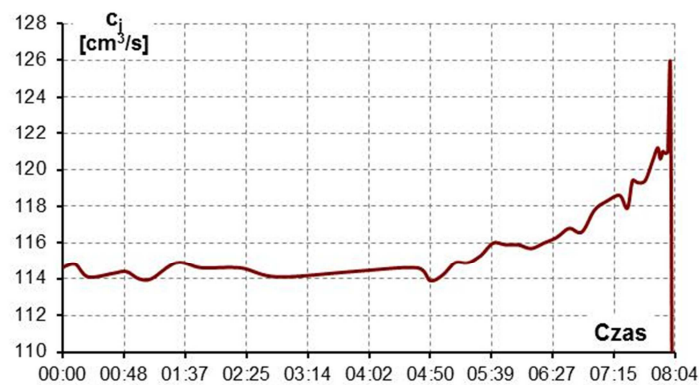
Rys. 9 Zmiana jednostkowego zużycia paliwa podczas próby z napływem czynnika obciążającego
