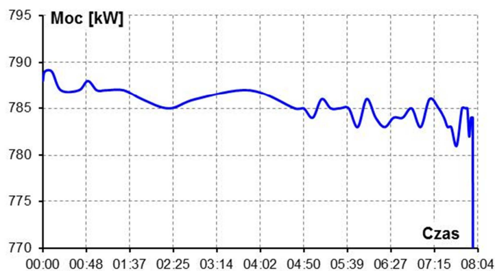
Rys. 5 Zmiana mocy silnika podczas próby z napływem czynnika obładzającego
