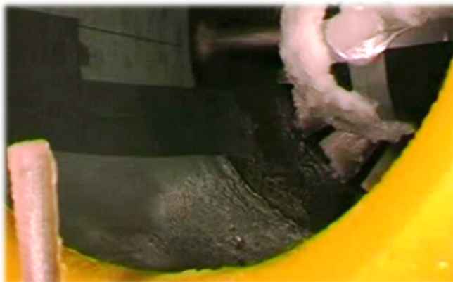
Rys. 13 Widok tunelu wlotowego silnika tuż po piątym (ostatnim) pompażu
