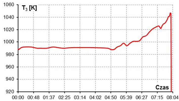
Rys. 7 Zmiana temperatury gazów wylotowych podczas próby z napływem czynnika obciążającego
